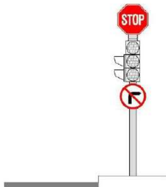
Σχήμα 2. Τοποθέτηση πινακίδων στον ιστό του σηματοδότη
